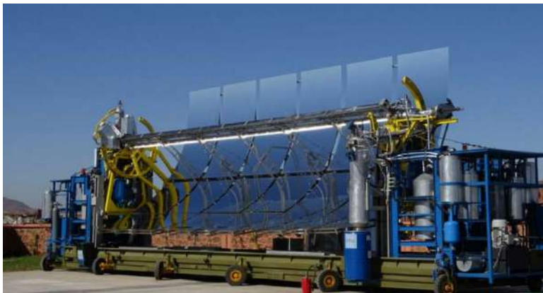
Vue d'un module de production d'hydrogène
