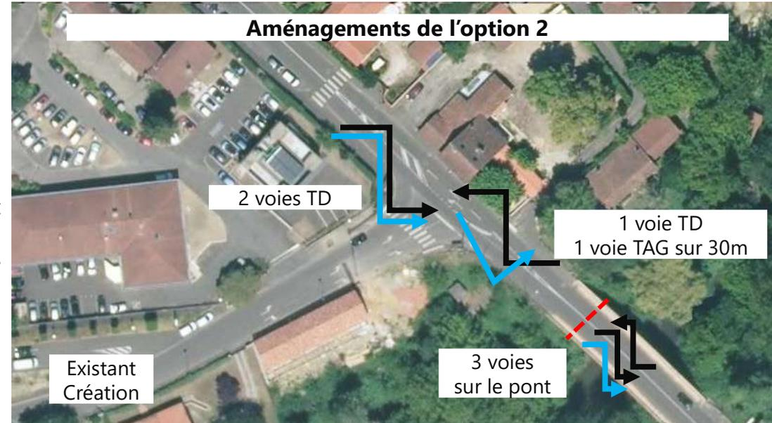
Aménagement préconisé sur l'intersection C5 : **Mise en place d'un carrefour à feux**
